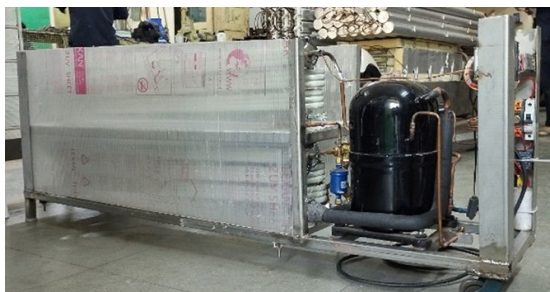
Rys. 6 Wielofunkcyjna pompa ciepła 1,5TR z możliwością chłodzenia mleka/ chłodzenia wody i podgrzewania wody (Indyjski Instytut Technologii w Bombaju , 2023).
