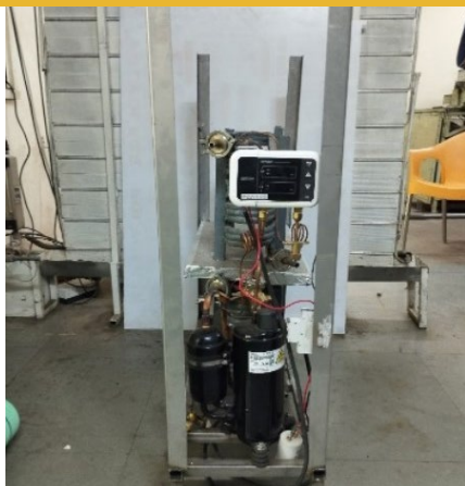
Rys. 5 Wielofunkcyjna pompa ciepła o mocy 1TR z możliwością chłodzenia mleka/wody, podgrzewania wody i suszenia (Indyjski Instytut Technologii w Bombaju , 2023).
